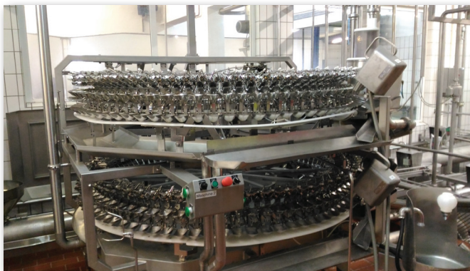
Оборудование для производства яичного меланжа (продукт для пищевой промышленности и кулинарии). Ознакомление с технологией в рамках визита в компанию «SoNovo».
